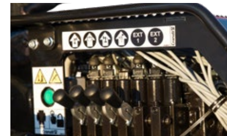
Stützbeinventil Elektrisch/manuell betätigt. 4-6-8 Sektionen, abgestimmt auf 1-Kreis, 2-Kreis und LS-System.
