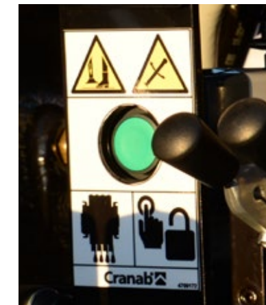
Aktivierungssperre Sicherheit bei der Bedienung des Stützbeinventils.
